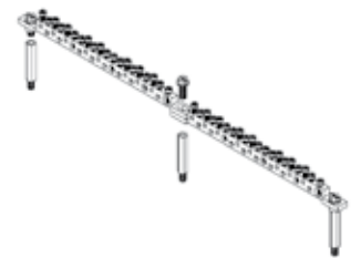
Befestigung auf Abstandshaltern und Erweiterung zu 2 Anschlüsse
