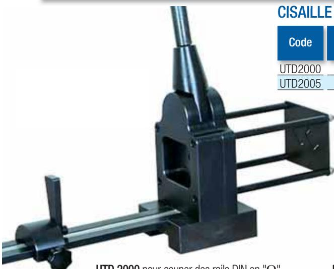
UTD 2000 pour couper des rails DIN en "Ω" symétriques (15 x 5,5 35 x 7,5 e 35 x 15)
